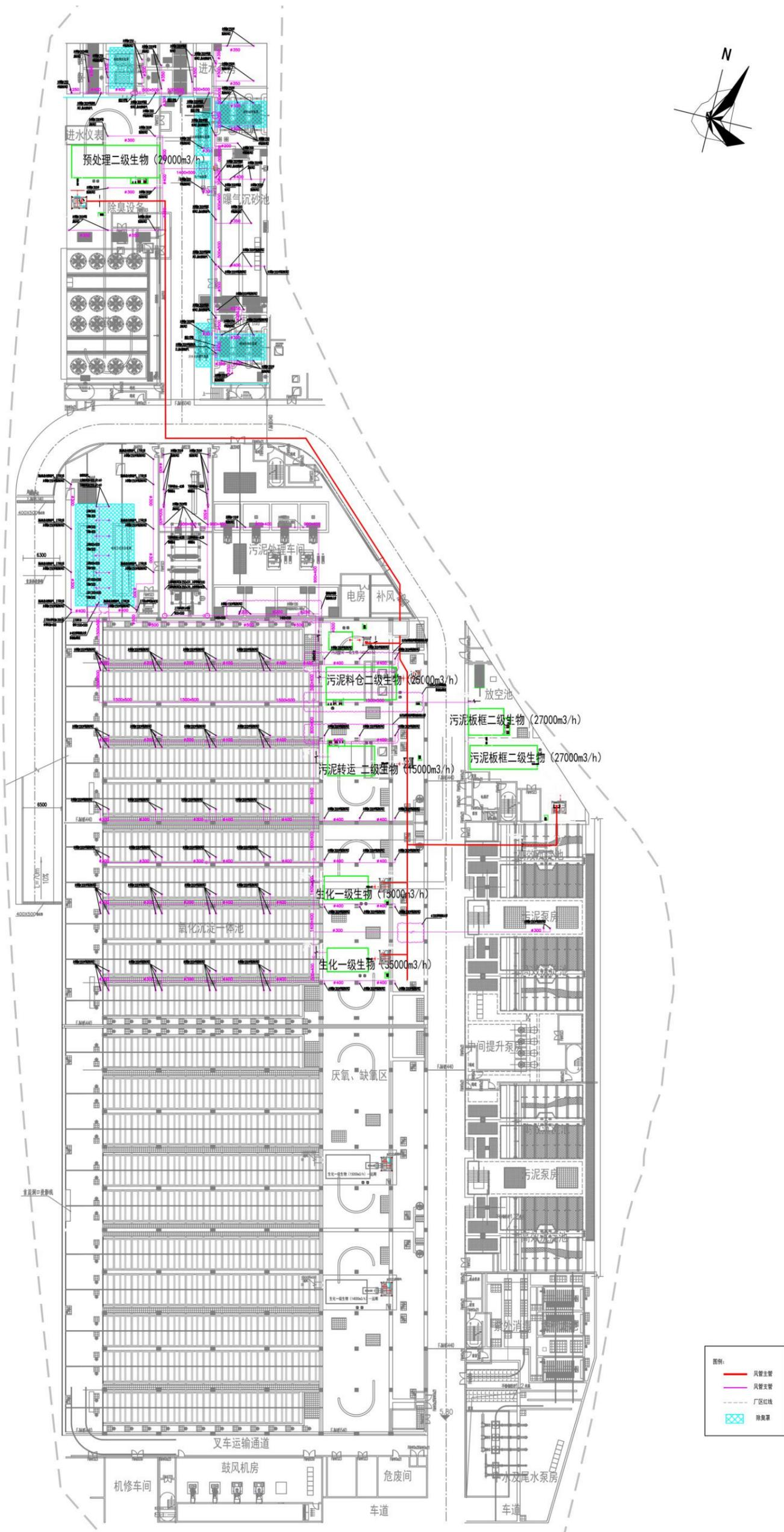
图 3.5-21 项目臭气收集管道、除臭设施平面布置图
