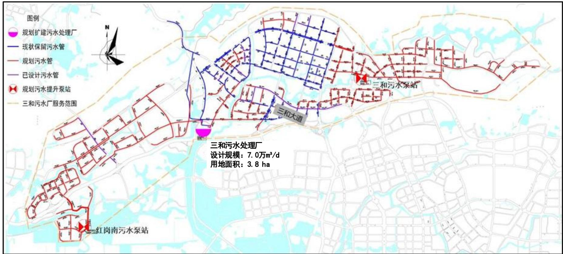
图 3.1-3 项目服务范围污水管网图
